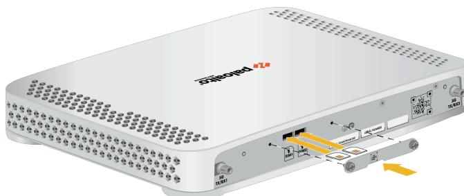
**STEP 3 |** Después de insertar la SIM, vuelva a colocar la tapa de la SIM en el dispositivo.
