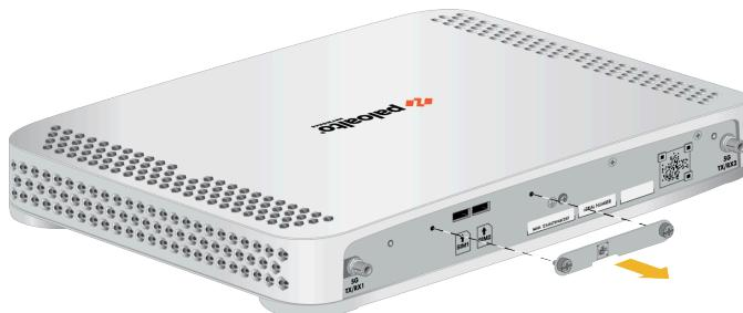
**STEP 2 |** Introduzca la nano SIM en la ranura SIM 1 o SIM 2 presionando la SIM en la ranura hasta que quede bloqueada en su posición.
