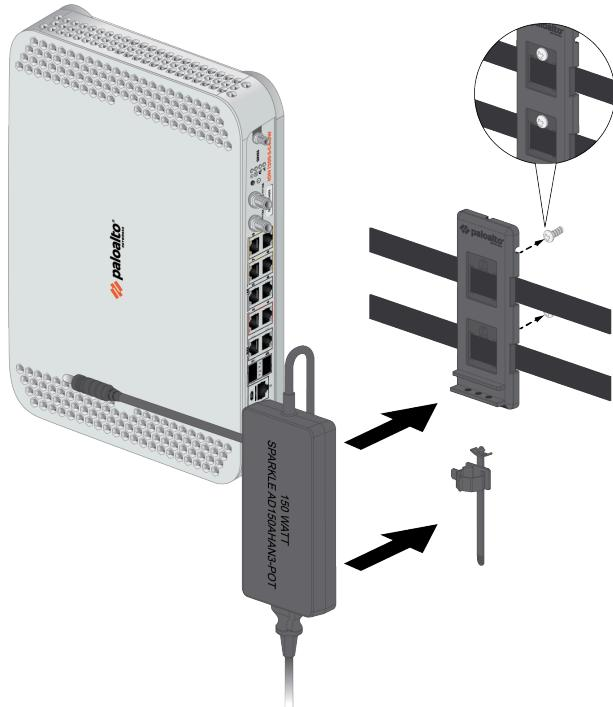
La siguiente imagen muestra una instalación completa para un ION 1200-S con un único adaptador de corriente. Si necesita una segunda fuente de alimentación, debe solicitar un adaptador de corriente y un kit de montaje en pared del adaptador por separado.
