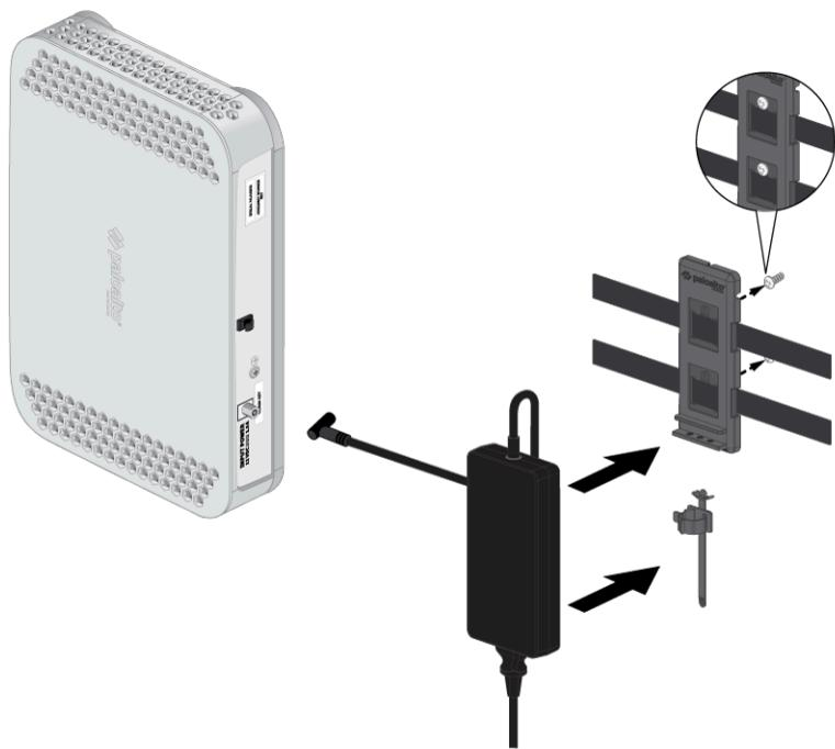
**STEP 5 |** Después de asegurar el adaptador de corriente al soporte, monte el soporte junto al cortafuegos con tornillos para madera o paneles de yeso, según corresponda.
