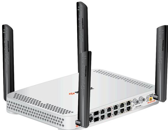
Verifique la intensidad de la señal del cortafuegos viendo el [indicador LED de señal móvil](#) o verificando la interfaz web del cortafuegos.
