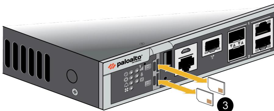
**STEP 3 |** Después de insertar la tarjeta SIM, vuelva a colocar la cubierta de la tarjeta SIM en el dispositivo y ajuste el/los tornillo(s).
