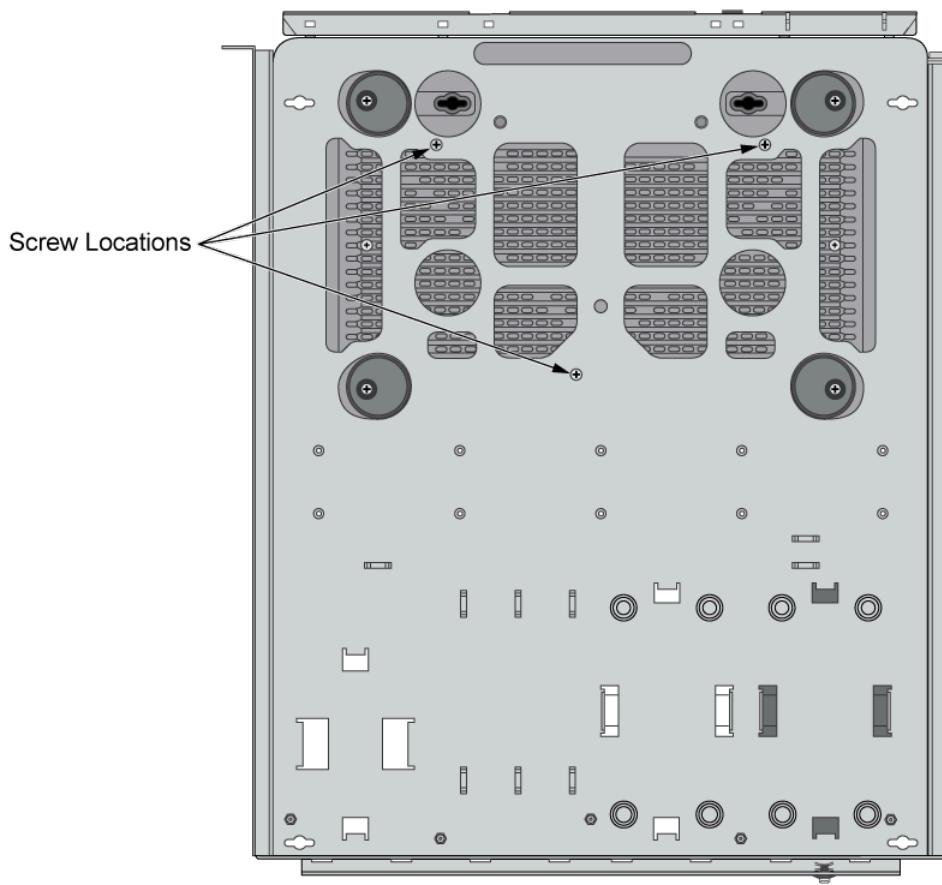
**STEP 7 |** (Si va a montar un segundo cortafuegos) Repita los pasos 4 a 6 para el segundo cortafuegos. Coloque el segundo cortafuegos junto al primer cortafuegos en la bandeja de montaje.
