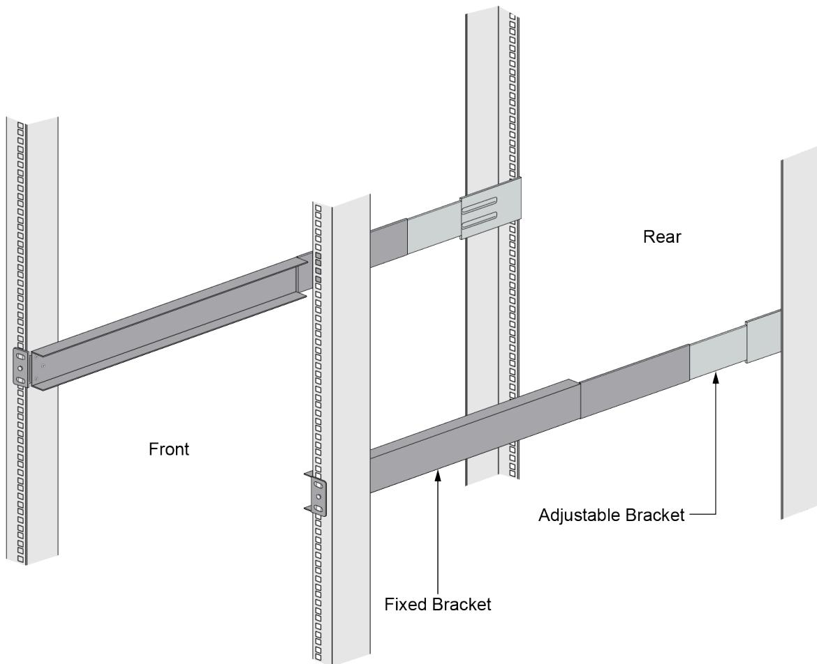
**STEP 2 |** Alinee el borde inferior de los rieles de montaje con la parte inferior de la unidad de rack reservada para el cortafuegos. Alinee los orificios ranurados en el soporte de montaje ajustable con los orificios en la parte posterior del bastidor del equipo.
