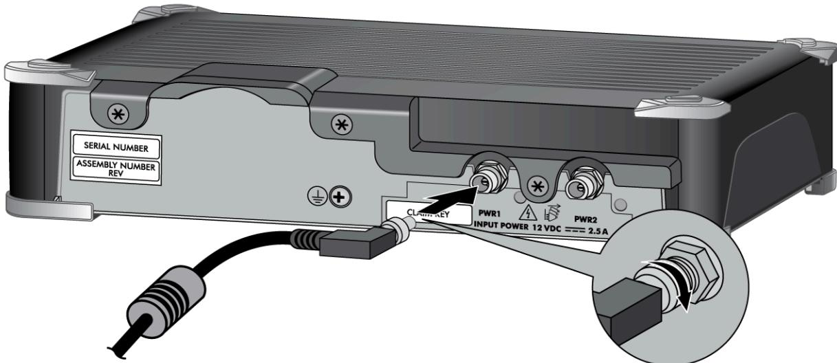
**STEP 4 |** Enchufe el conector del adaptador de corriente a su fuente de alimentación. Una vez conectado el suministro, el cortafuegos se enciende como lo indica el LED de alimentación
