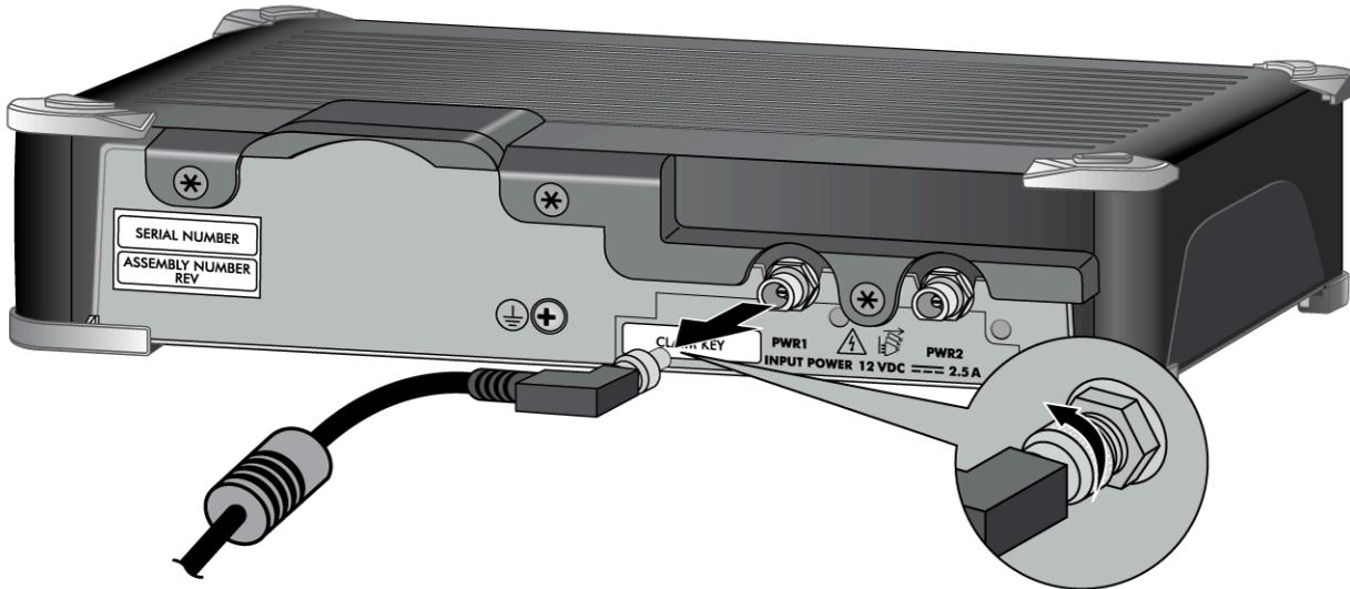
(PA-410) Desenchufe el adaptador de corriente defectuoso de la fuente de alimentación de CA y extraiga el cable de alimentación del cortafuegos para quitarlo.
