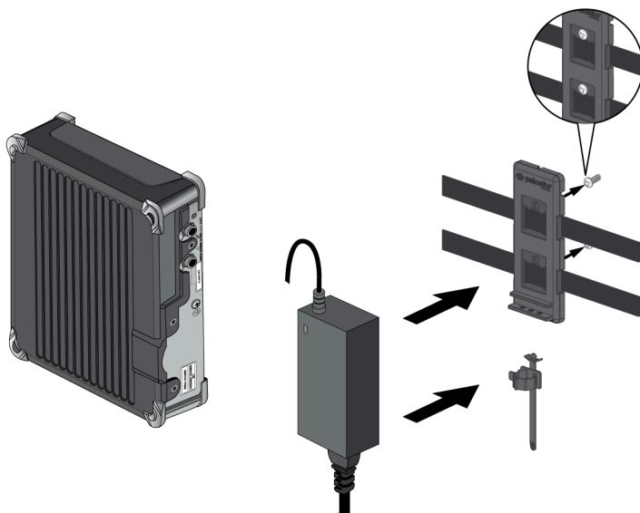
(PA-415, PA-415-5G, PA-455, PA-455-5G, y PA-445) Instale el adaptador de corriente en el soporte de montaje en pared del adaptador de corriente usando las correas de velcro y la brida para cables. Asegúrese de alinear la brida para cables con las muescas del soporte para evitar que el cable de alimentación se caiga. Luego, pase las dos correas de velcro a través de las aberturas laterales del soporte de pared y sobre el adaptador de corriente. Por último, vuelva a
