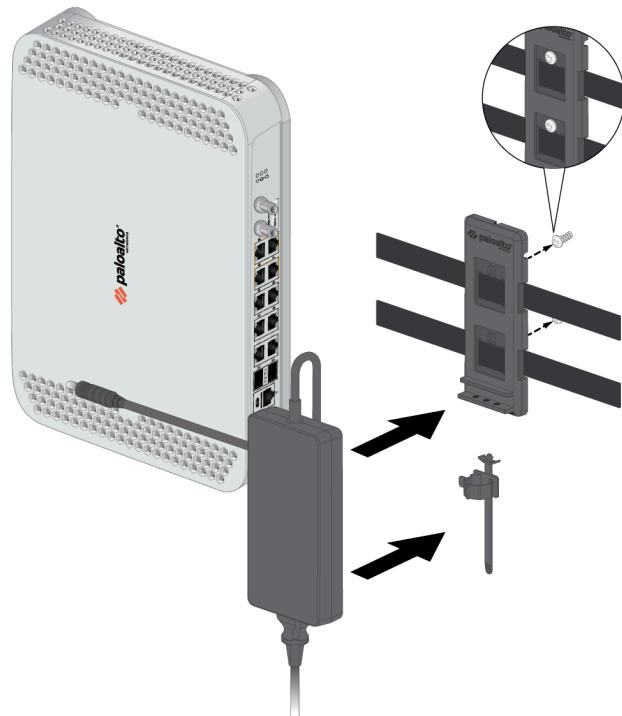
(PA-410) Instale el adaptador de corriente en el soporte de montaje en pared del adaptador de corriente usando las correas de velcro y la brida para cables. Asegúrese de alinear la brida para cables con las muescas del soporte para evitar que el cable de alimentación se caiga. Luego, pase las dos correas de velcro a través de las aberturas laterales del soporte de pared y
