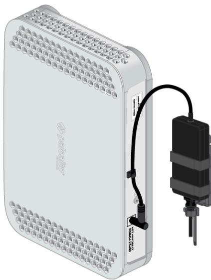
**STEP 6 | (PA-415, PA-415-5G, PA-440, PA-445, PA-450, PA-455, PA-455-5G, y PA-460)** Puede instalar un segundo adaptador de corriente opcional junto al primer adaptador de corriente.
