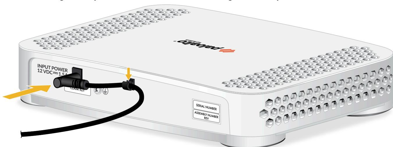
**STEP 3 |** Asegúrese de que el adaptador de corriente esté en la posición adecuada (consulte [Instalación del cortafuegos PA-400 Series](#)).
