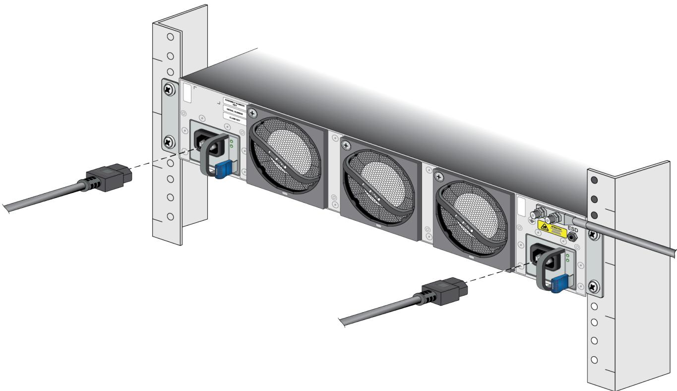
2. Asegure los cables de alimentación a las entradas de alimentación con las correas de velcro.
