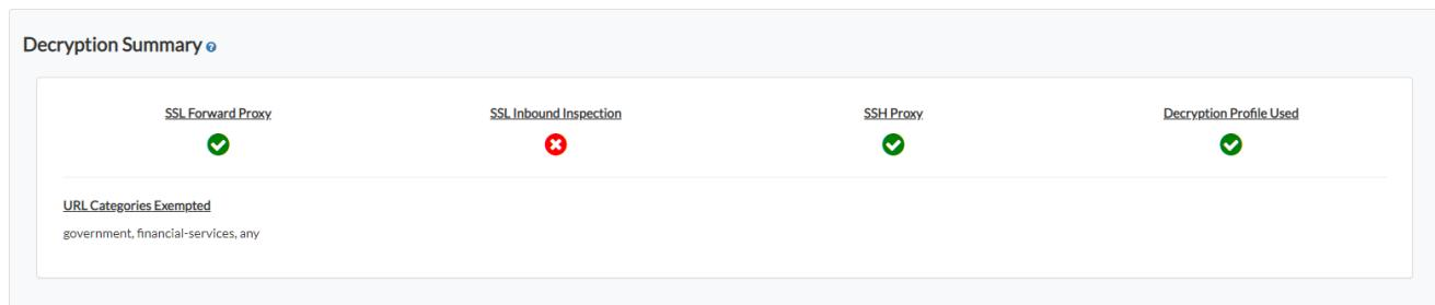
**Decryption Summary** (Résumé du déchiffrement) : indique si la configuration inclut des règles de politique de déchiffrement pour le proxy de transfert SSL, l'inspection SSL entrante et le proxy SSH. Le résumé indique également si la configuration inclut des profils de déchiffrement et identifie les catégories d'URL que l'équipement exclut du déchiffrement.
