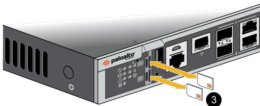
**STEP 3 |** SIMを挿入したら、SIMカバーをデバイスに戻し、ネジを締めます。
