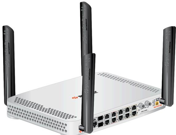
**Cellular LED**を確認するか、ファイアウォールWebインターフェースを確認して、ファイアウォールの信号強度を確認します。
