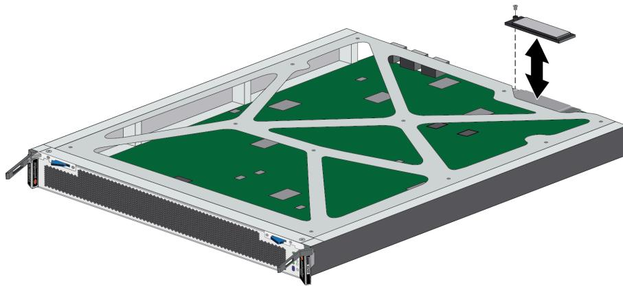
**STEP 11 |** 新しい SSD を空き嵌合コネクタにスライドさせます。SSDがカードのプラスチックスタンードオフと一致していることを確認します。
