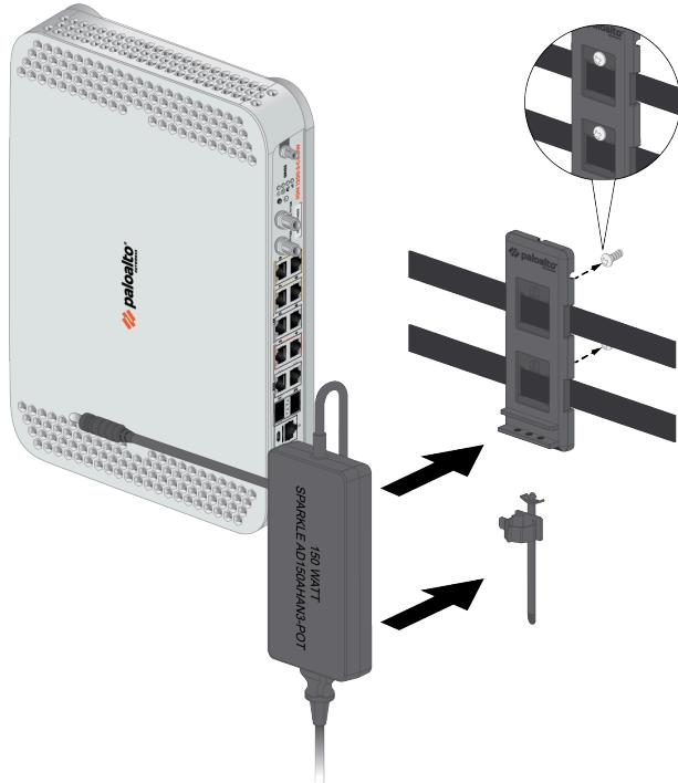
다음 이미지는 단일 전원 어댑터가 장착된 ION 1200-S가 설치 완료되었음을 보여줍니다. 두 번째 전원 공급 장치가 필요한 경우 전원 어댑터와 어댑터 벽면 장착 키트를 별도로 주문해야 합니다.
