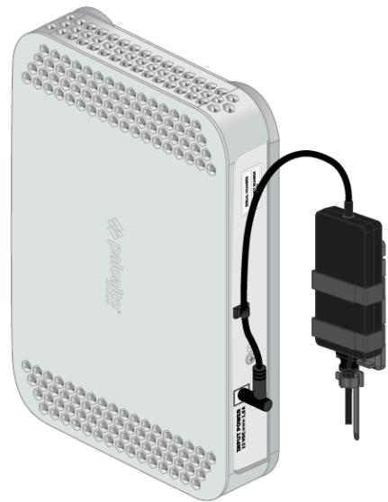
**STEP 6 |** (**PA-415, PA-415-5G, PA-440, PA-445, PA-450, PA-455, PA-455-5G 및 PA-460**) 두 번째 전원 어댑터(선택 사항)를 첫 번째 전원 어댑터 옆에 설치할 수 있습니다.
