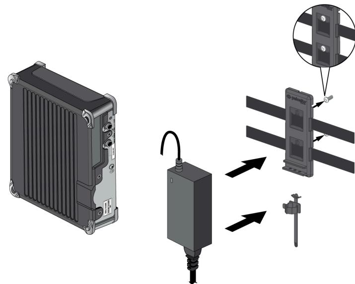
(PA-415, PA-415-5G, PA-455, PA-455-5G 및 PA-445) 전원 어댑터를 벨크로 스트랩과 케이블 타이를 사용하여 전원 어댑터 월 마운트 브래킷에 설치합니다. 케이블 타이를 브래킷의 홈에 맞추어 전원 코드가 빠지지 않는지 확인합니다. 그런 다음 2개의 벨크로 스트랩을 월 마운트 측면 구멍으로 통과시
