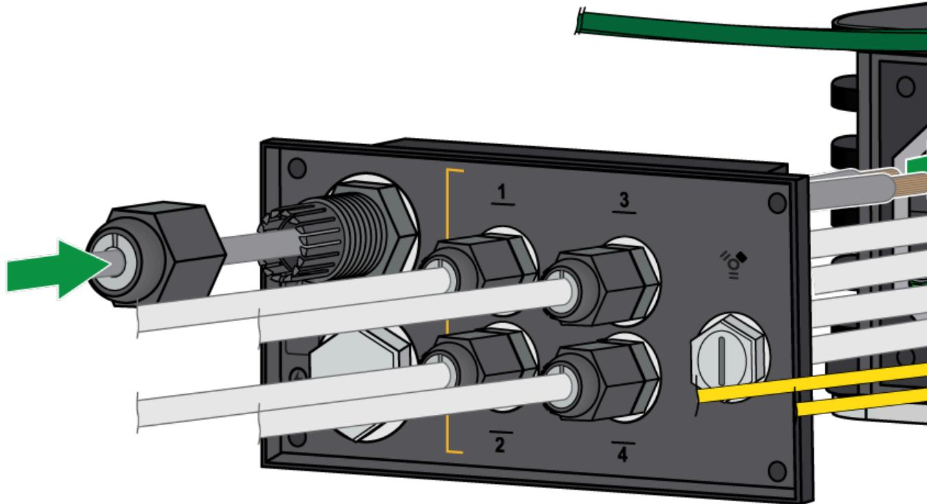
**STEP 5 |** 양극 및 음극 DC 케이블을 단자판에 삽입합니다. 단자판은 12~30AWG 케이블을 지원하며 그 중에서도 16AWG를 사용하는 것이 좋습니다. 1/8" 일자 드라이버를 사용하여 각 케이블을 고정합니다. 단자 나사가 꽉 조일 때까지 시계 방향으로 돌립니다. 나사를 2in-lbs가 넘는 토크로 조이지 마십시오.
