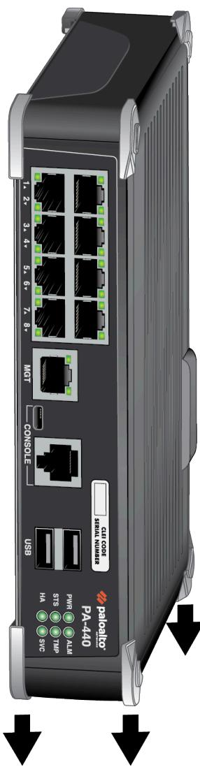
Os firewalls PA-410, PA-415, PA-415-5G, PA-455, PA-455-5G e PA-445 têm pés de borracha instalados no lado inferior, de modo que só podem ser instalados na posição horizontal.
