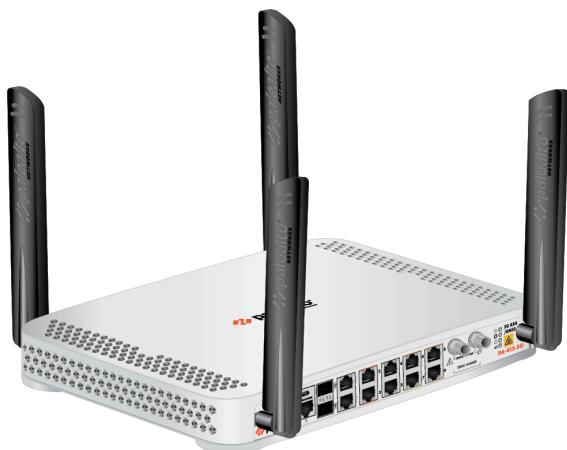
Чтобы определить силу сигнала брандмауэра, проверьте [светодиод сотовой связи](#) или веб-интерфейс брандмауэра.
