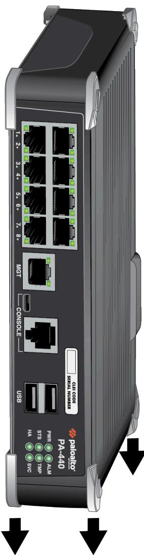
У брандмауэров PA-410, PA-415, PA-415-5G, PA-455, PA-455-5G и PA-445 имеются резиновые ножки с нижней стороны, поэтому их можно устанавливать только в горизонтальном положении.
