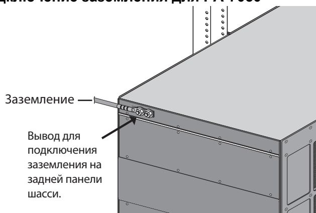
Рисунок 42. Подключение заземления для PA-7050
