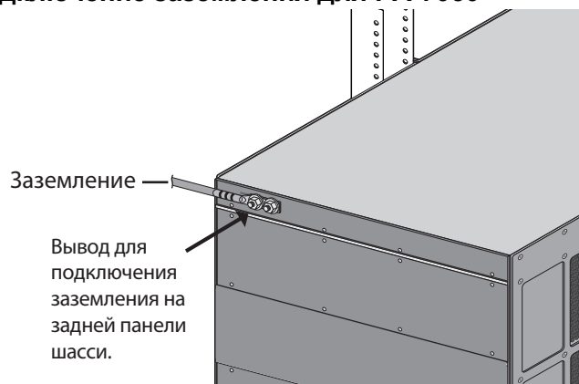
Рисунок 40. Подключение заземления для PA-7050
