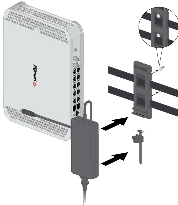
(PA-440、PA-450 和 PA-460) 使用魔术贴绑带和扎带将电源适配器安装在电源适配器壁挂式支架中。确保将电缆扎带与支架上的凹槽对齐，以防电源线脱落。接下来，将尼龙搭扣带穿
