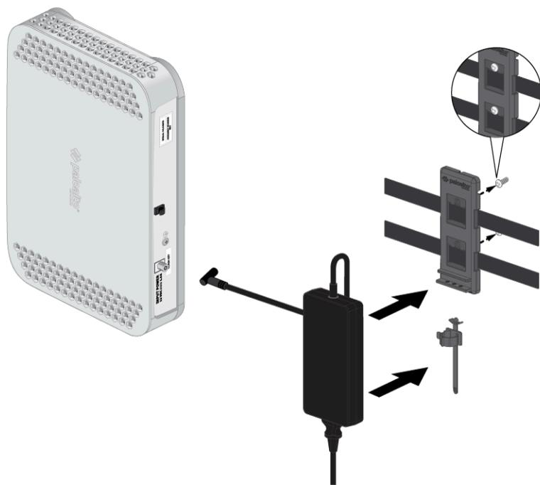
**STEP 5 |** 将电源适配器固定到支架上后，酌情使用木质或石膏板螺丝将支架安装在防火墙旁边。
