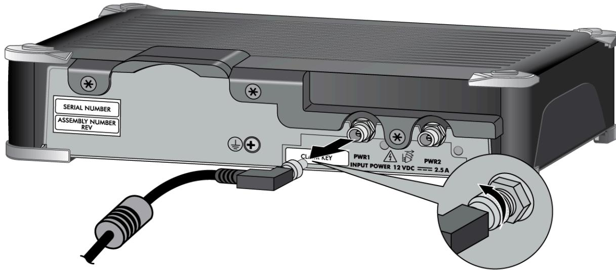
(PA-410) 从交流电源上拔下发生故障的电源适配器，并将电源线拉出防火墙以将其卸下。
