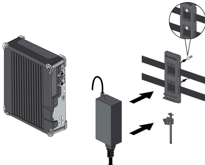
(PA-415、PA-415-5G、PA-455、PA-455-5G 和 PA-445) 使用尼龙搭扣带和电缆束带将电源适配器安装在电源适配器壁挂式支架中。确保将电缆扎带与支架上的凹槽对齐，以防电源线
