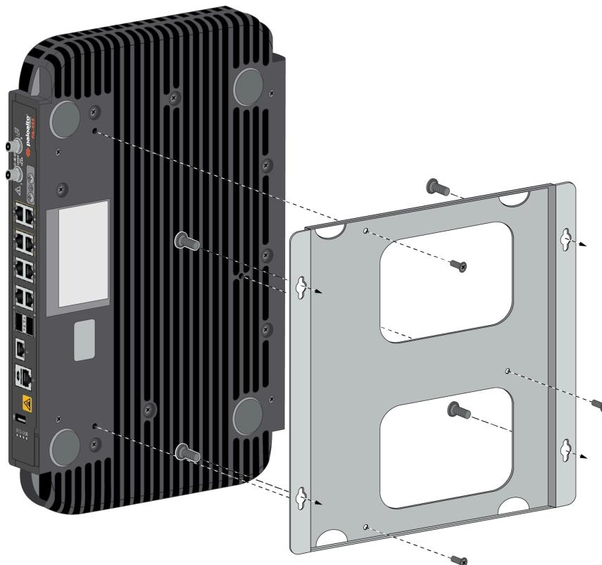
**STEP 4 |** 将电源适配器安装在电源适配器壁挂式支架中。
