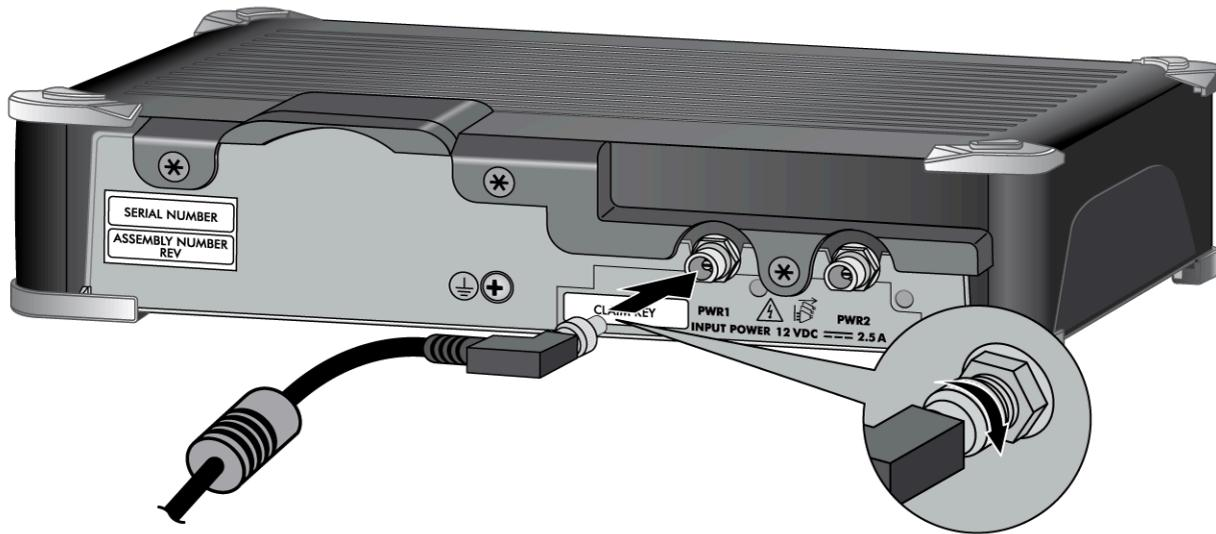
**STEP 4 |** 将电源适配器的交流连接器插入电源。连接电源后，防火墙会启动，如 **PWR 1** 端口旁的绿色电源 LED 指示灯所示。连接正常工作的电源适配器时，前 **PWR LED** 指示灯呈绿色亮起。
