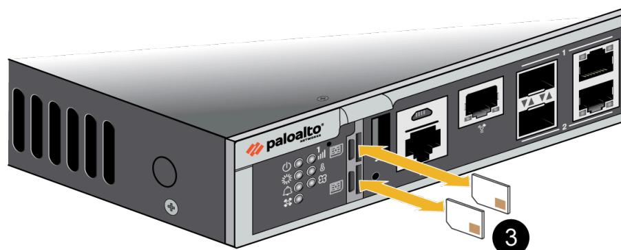
**STEP 3 |** 插入 SIM 后，将 SIM 盖板放回设备上并拧紧螺丝。
