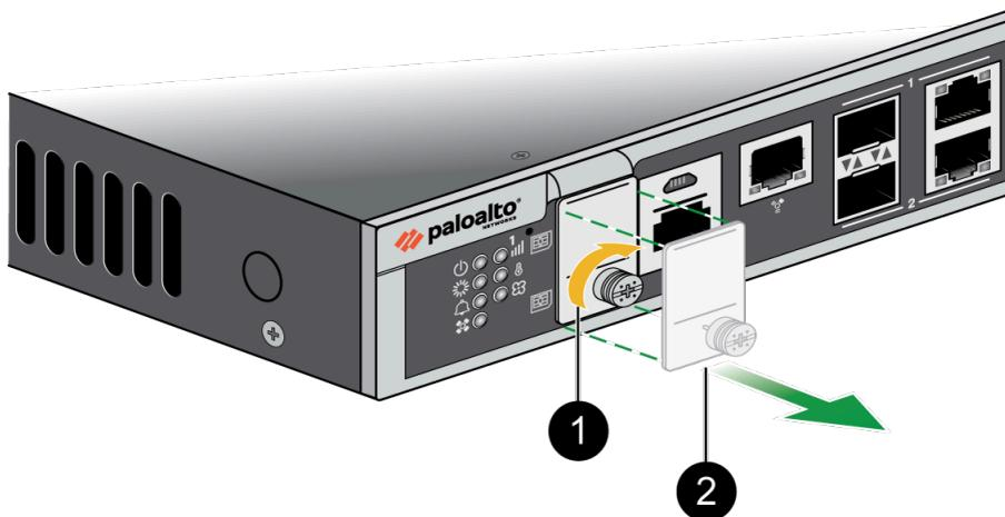
**STEP 2 |** 让 SIM 卡的切角（斜边）朝向插槽，将 SIM 卡轻轻推入 SIM 1 或 SIM 2 插槽，直到 SIM 卡卡入到位。
