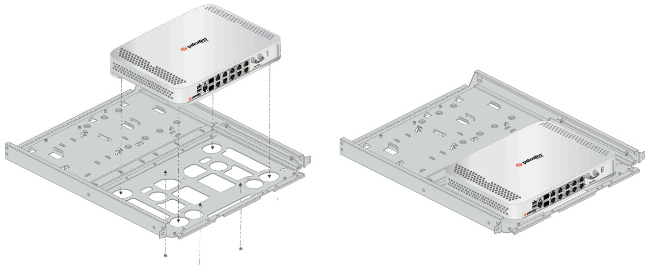
**STEP 5 |** 在握住防火墙的同时，小心翻转安装托盘，使其露出底面。
