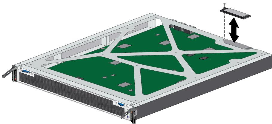
**STEP 11 |** 将新 SSD 滑入空的配合连接器。确保 SSD 与该卡上的塑料支座对齐。
