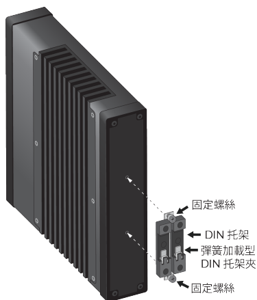
將 DIN 托架安裝在背部
