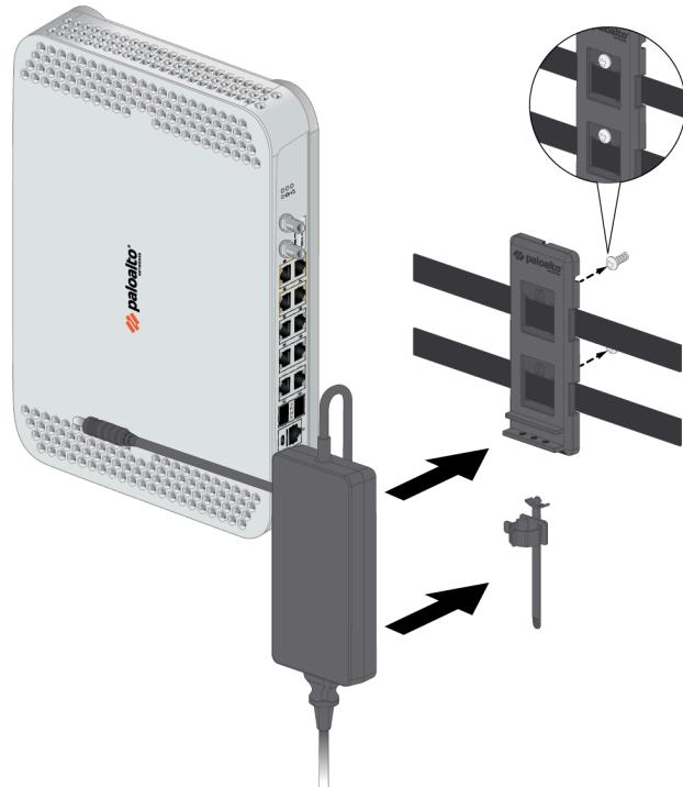
**(PA-410)** 使用魔術貼帶和纜線帶，將電源轉換器安裝在電源轉換器壁掛式支架中。請務必將纜線帶與支架中的凹槽對齊，以防止電源線脫落。接下來，將兩個魔術貼帶穿過壁掛架的側面開口和電源轉換器上。最後，將魔術貼帶繞回電源轉換器的頂部，以將其固定。
