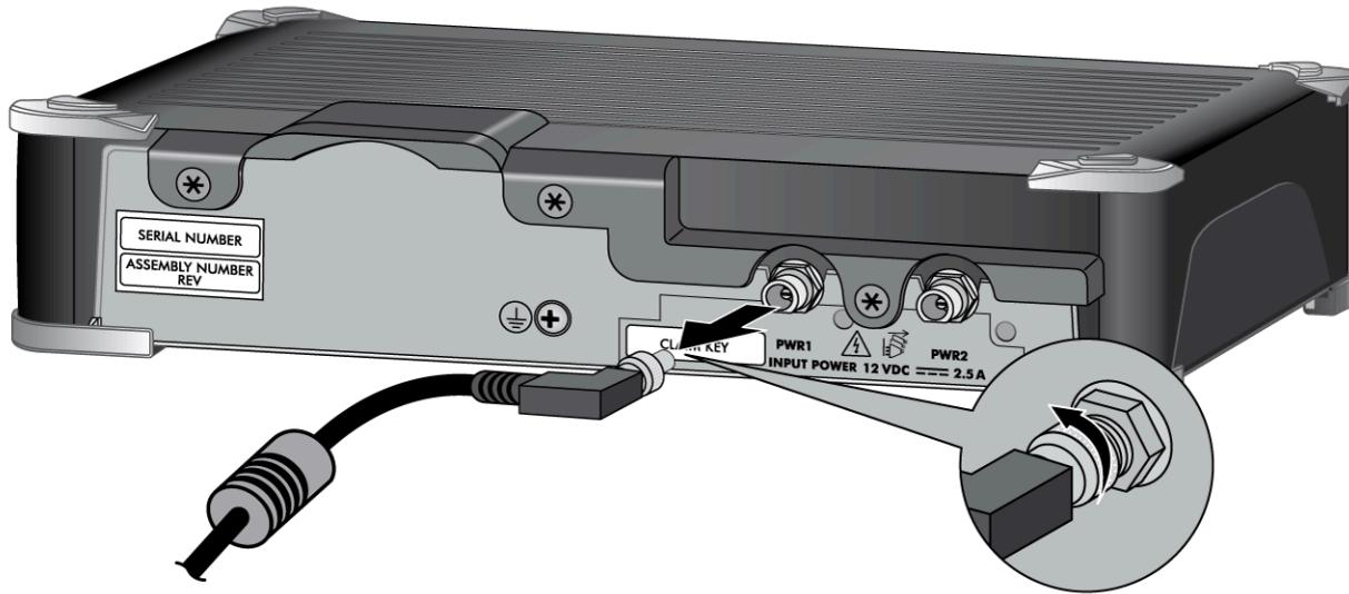
(PA-410) 從交流電源中拔除故障的電源轉換器，然後將電源線從防火牆上拔掉。
