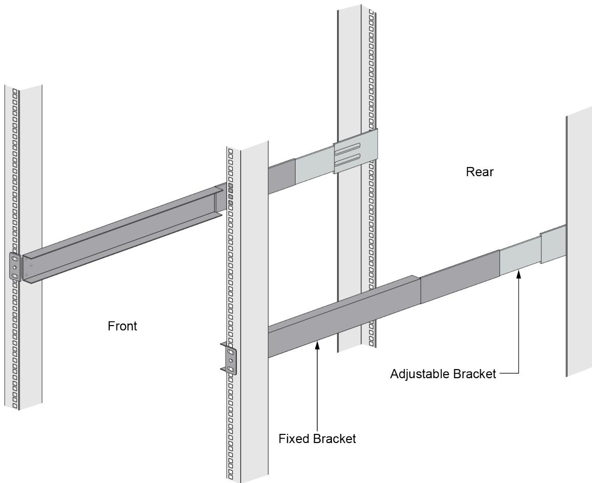
**STEP 2 |** 將安裝導軌的底部邊緣與為防火牆保留的 1 RU 底部對齊。將可調式安裝支架中的開槽孔對齊設備框架後方的孔洞。
