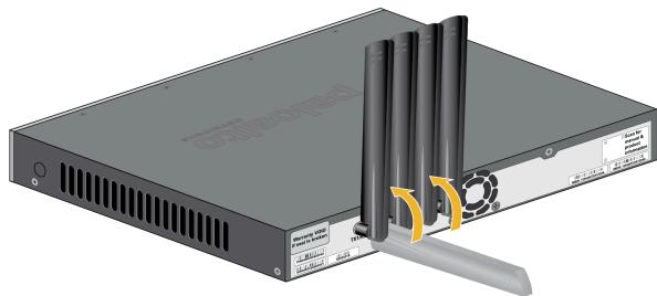
**STEP 2 |** 調整天線方向，以接收您環境中的最佳訊號強度。
