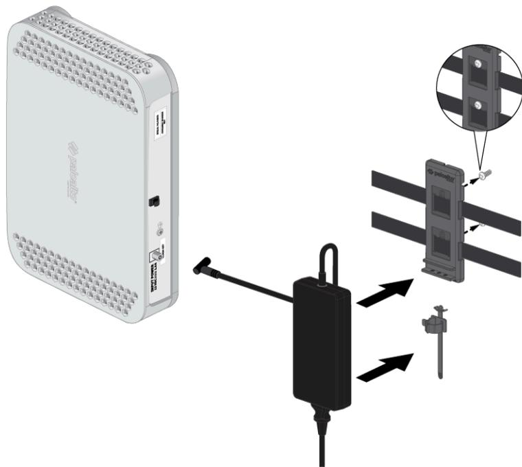
**STEP 5 |** 將電源轉換器固定在支架上後，請視需要使用木頭或石膏板螺絲，將支架安裝在防火牆旁邊。
