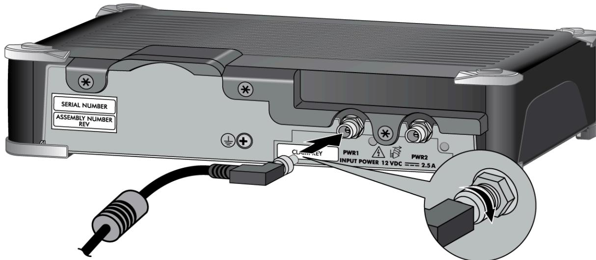
**STEP 4 |** 將電源轉換器的連接器插入電源。連接電源後，防火牆電源會開啟，如 **PWR 1** 連接埠旁邊的綠色電源 LED 燈所示。連接正常運作的電源轉換器時，前方 **PWR LED** 燈會顯示綠色。
