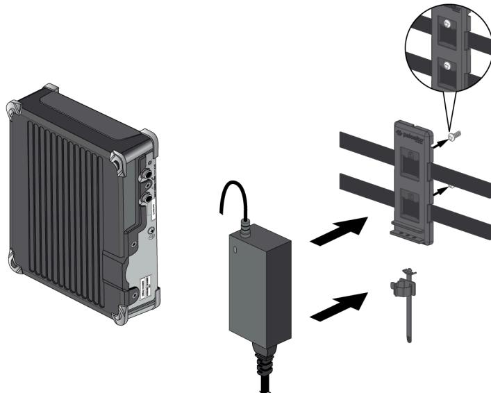
(PA-415、PA-415-5G、PA-455、PA-455-5G 和 PA-445) 使用魔術貼帶和纜線帶，將電源轉換器安裝在電源轉換器壁掛式支架中。請務必將纜線帶與支架中的凹槽對齊，以防止電源線
